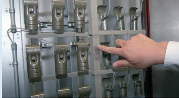
▲誘導加熱コイルによる乾燥設備の概要
